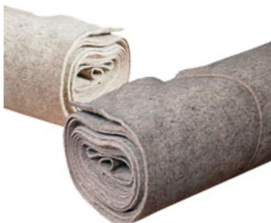
Войлок – старейший материал, изобретенный древним человеком. И в то же время - очень современный материал, который обладает уникально низкой теплопроводностью, достаточно хорошо пропускает воздух, имеет небольшой собственный вес. Войлок используется в машиностроении, точном приборостроении, в качестве прокладок, сальников, фильтров между металлическими поверхностями для предохранения их от истирания, загрязнения, для смягчения ударов, сотрясений.
